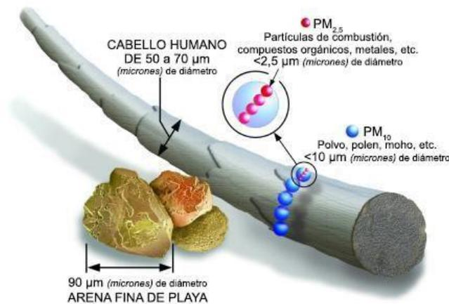
Figura 4 Comparación del tamaño de las partículas-Fuente: USEPA<sup>4</sup>
